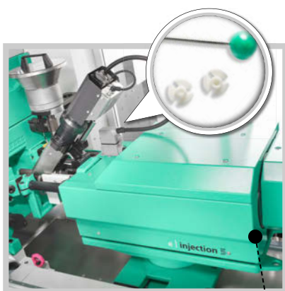
微型注塑： 使用尺寸為 5 的微型注射單元， 實現最小注射重量。
