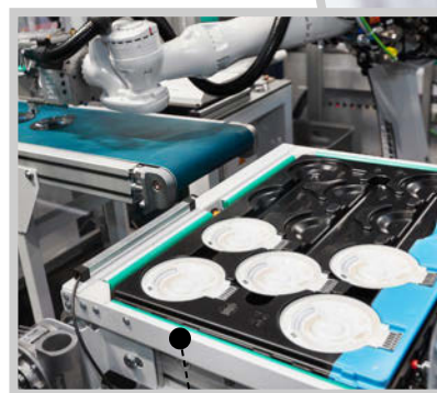
模內薄膜注塑： 採用伺服電驅動， 實現較高的重複能力。
