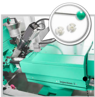
Microstampaggio a iniezione: pesi della stampata minimi con unità di microstampaggio a iniezione di grandezza 5.
