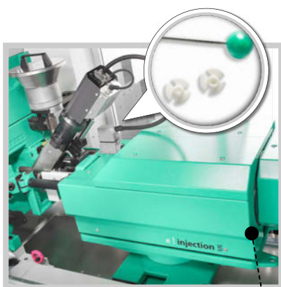
Micro-injection : poids injectés minimes avec l'unité de micro-moulage de taille 5.
