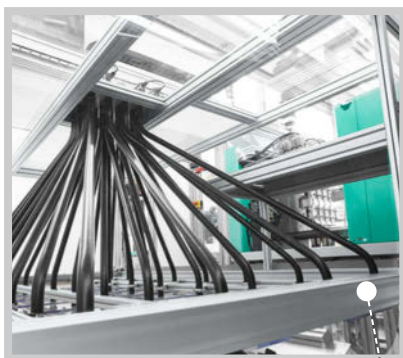
Gesicherte Qualität: pro Stunde rund 18.000 Spulenkörper nach Kavitäten getrennt bereitstellen.
