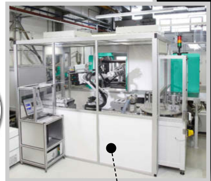
Displayfolien partikelfrei hinterspritzen: individuelle Turnkey-Lösung aus einer Hand.
