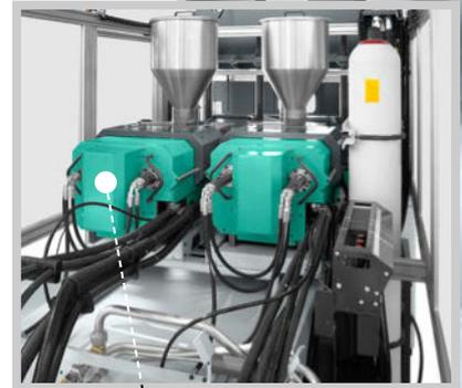
P-Stellung: zweite Spritzeinheit horizontal parallel zur ersten.
