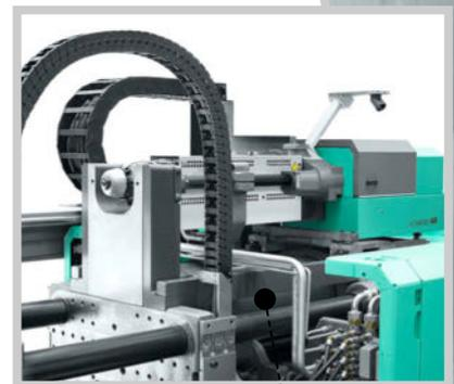
M-Stellung: zweite Spritzeinheit mitfahrend über der beweglichen Aufspannplatte angeordnet.
