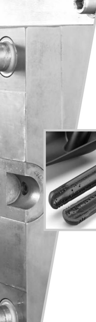
Leicht und gleichzeitig mechanisch belastbar: WIT oder GIT erzeugen gezielt Hohlräume im Bauteil.
