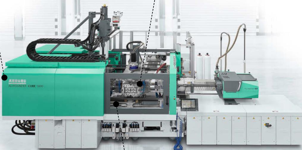
Großzügiger Einbauraum – optimiert für Platzbedarf von Würfelwerkzeugen.
