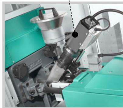
Flexibel: das Mikrospritzmodul lässt sich einfach durch ein Standard-Zylindermodul ersetzen.
