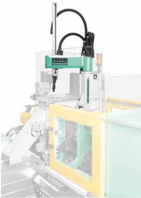
Bild 3. Praxisorientierte Lösung für kurze Rüst- und Zykluszeiten: ein servoelektrischer Integralpicker zur Angussentnahme
