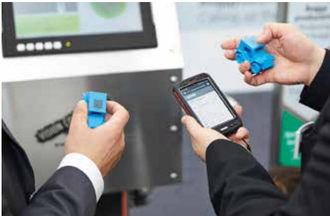
Bild 2. Industrie 4.0 praxisnah: Das Beispiel eines Spielzeug-Buggys mit individualisiertem Code zeigt, wie sich die Produktionseinheiten vernetzen und Daten teilebezogen archivieren lassen
