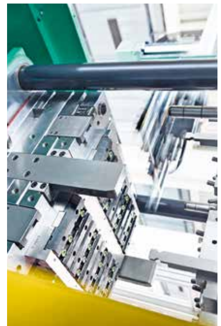
Bild 4. Bei Schnellläufer-Anwendungen kann ein lineares Robot-System mit schnell eingreifender Tauchachse im Vergleich zu einer speziell ausgelegten Automation die bessere Option sein
