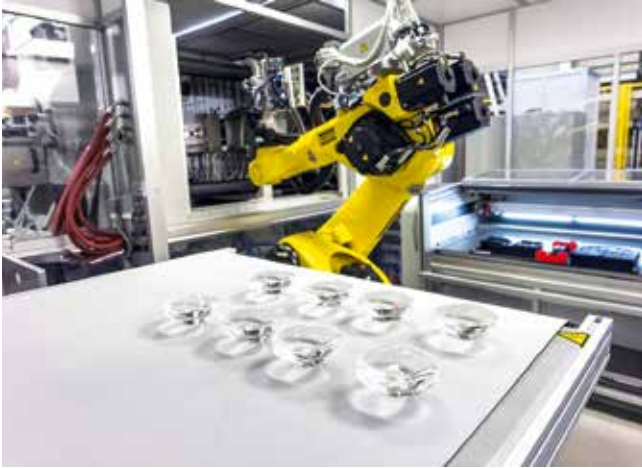
Bild 8. Während die dicken Linsen im Werkzeug abkühlen, führt der Sechssachsroboter weitere Produkte einer Laserbearbeitung (hinten rechts im Bild) zu (Bild: Erco, Dirk Vogel)
