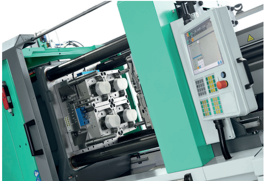
Bild 1. Typisch für schnelllaufende Anwendungen mit kurzen Einspritzzeiten sind Dünwandartikel wie Rundbecher, hier mit einem 4-fach-Testwerkzeug
