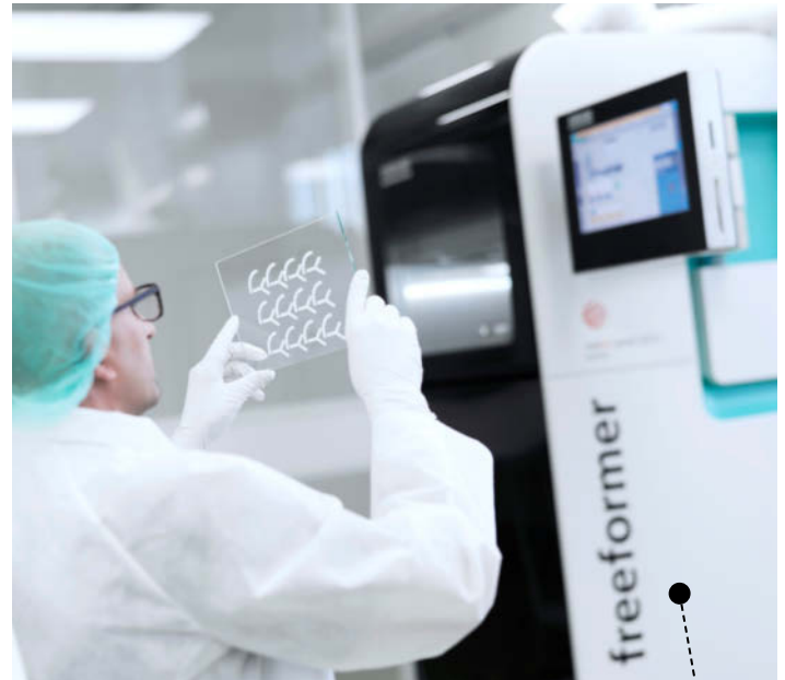
Additive Fertigung von Implantaten mit dem freeformer
