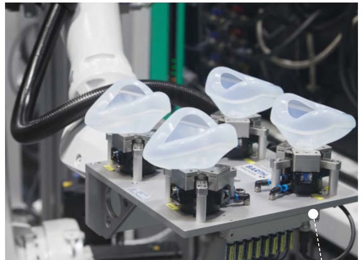
ARBURG engagierte sich in der Coronakrise: Projektteam mit Turnkey-Spritzgießanlage (oben) und LSR-Masken (unten).
