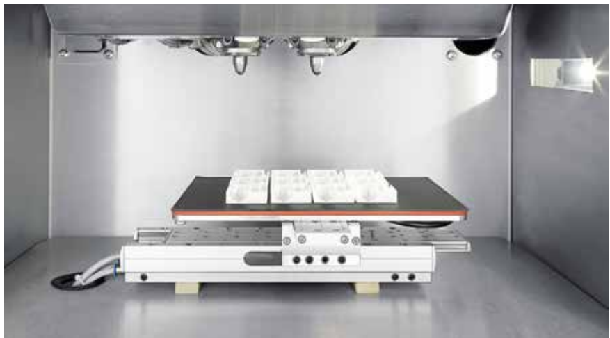
Bild 2. Auf Arburgs Technologie-Tagen 2014 produzierte ein Freeformer je zwölf Steckergehäuse aus ABS als Ersatzteile für Allrounder-Spritzgießmaschinen
