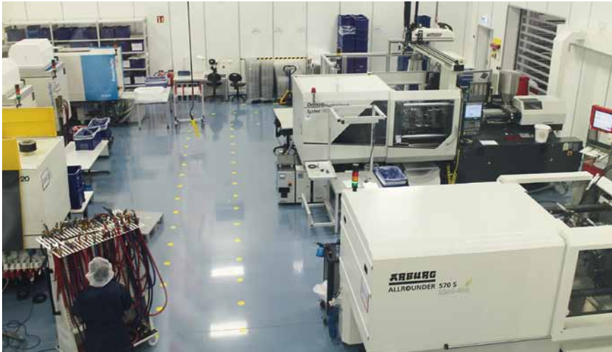
▲ Das TCC verfügt über eine Small Batch Production mit eigenem Reinraum der ISO-Klasse 8 und ISO Klasse 7 für eingeschränkte Bereiche.
