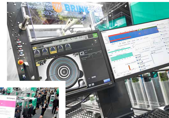
交鑰匙系統的核心：一台配備尺寸為 1300 新型注射單元的電動注塑機 ALLROUNDER 720 A（左圖）。模具中的傳感器保證產品質量完美無瑕（上圖）。
