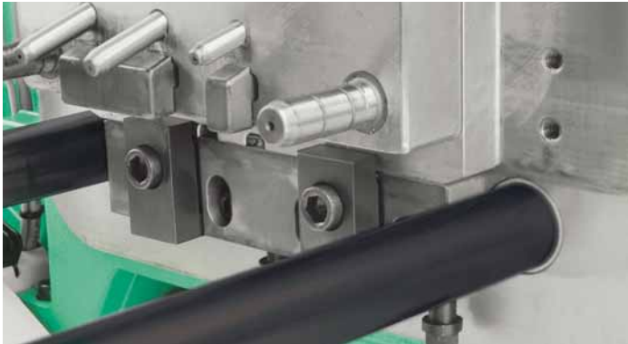
Slitta di guida e stampo montato con relativo perno di riferimento innestato
