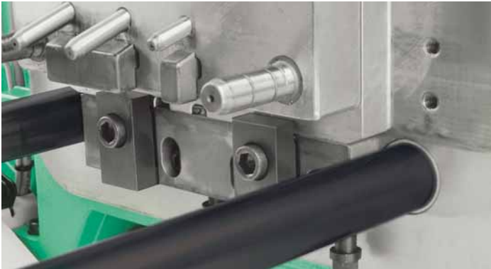
Führungsschiene und montiertes Werkzeug mit eingerastetem Indexbolzen
