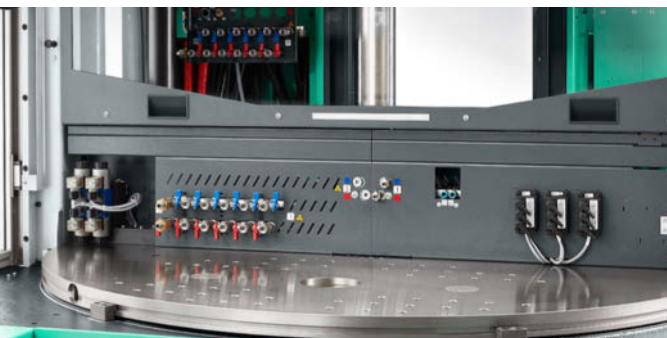
Das säulenfreie Drehtischkonzept macht Medienanschlüsse einfach zugänglich.
