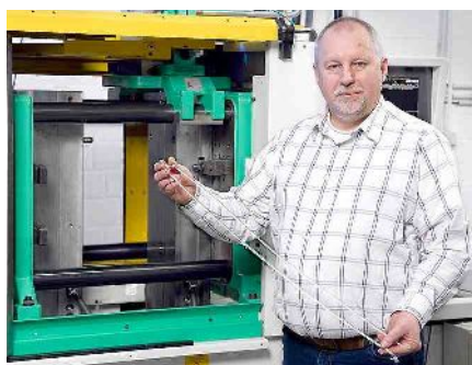
Le chef de production Christian Broich (en bas à gauche) montre le conducteur optique injecté à la verticale sur une ALLROUNDER 420 C dans un moule d'un mètre (en bas).
