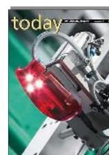
Con la produzione, in un solo processo, di un fotoconduttore LED pronto per l'uso, ARBURG insieme ad Oechsler AG ha mostrato, in occasione della K 2007, una delle tendenze del futuro.
