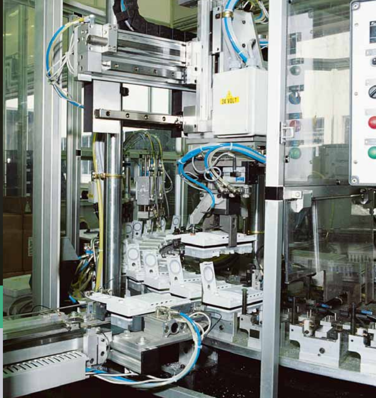
Le montage des unités de dosage pour lave-vaisselle est entièrement automatisé. Après l'injection, les pièces sont assemblées pour donner des éléments prêts à être montés sur les appareils.
