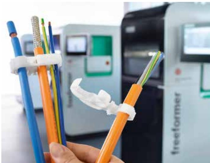
**Bild 8.** Auf dem Freeformer additiv gefertigte Kabelklemmen aus teilkristallinem Standard-PP zeichnen sich durch filigrane Strukturen und einen spritzgießtypischen Klick-Effekt aus (© Arburg)
