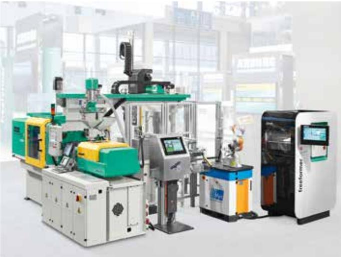
**Bild 14.** Bei einer informationstechnisch komplett vernetzten und durchgehend automatisierten Fertigungslinie für individualisierte Großserienteile bestückt ein Siebenachsroboter den Bauraum des Freeformers (© Arburg)
