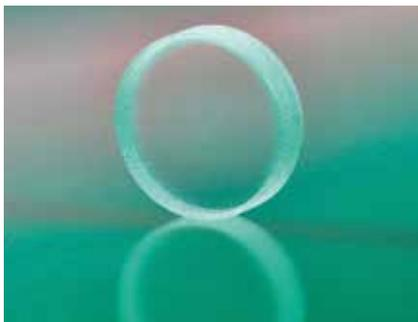
**Bild 6.** Werden die Tropfen extrem dicht gepackt, lassen sich im AKF-Verfahren transparente Testscheiben aus PMMA erzeugen
