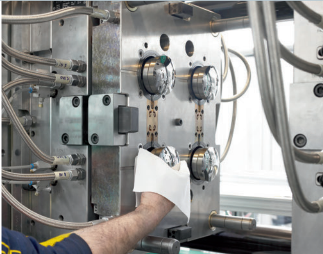
Bild 3. Werkzeugeinsätze ermöglichen durch ihre Austauschbarkeit schnelle Produktwechsel; die hochpräzisen Funktionsflächen werden für eine genaue Abformung mit Diamanten bearbeitet
